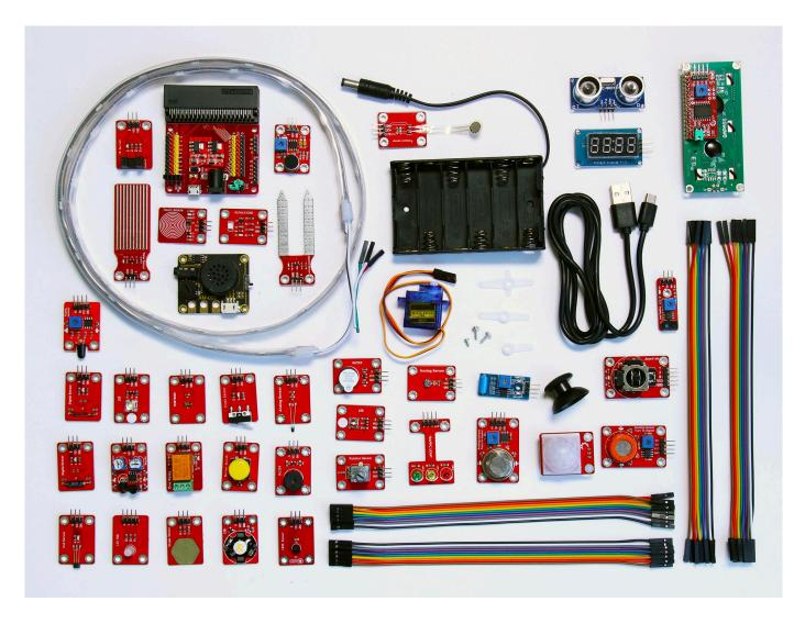
La placa de expansión se puede conectar a una fuente de alimentación externa (DC 6-12V, interfaz PH2.0-2P) y cuenta con un interruptor DIP para controlar la energía. Viene con dos grupos de pines de 4 pines extendidos para la interfaz de comunicación I2C (suministro de energía de 3.3V y 5V). Otros dos conjuntos de pines de 4 pines están extendidos para P12 y P13 (suministro de energía de 3.3V y 5V).
